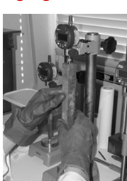
Ensaio acelerado de barra de argamassa (28 dias a 80°C)
