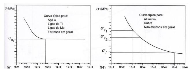
Os gráficos acima apresentados são típicos de um ensaio de fadiga, mostrando o comportamento da tensão (dinâmica) em função no número de ciclos.
