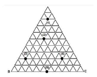
10. A figura a seguir mostra uma seção isotérmica do diagrama do sistema A-B-C. As ligas X e Y têm composições (51,1% de A, 6,3% de B e 44,8% de C) e (58,7% de A, 21,7% de B e 19,6% de C) respectivamente.
