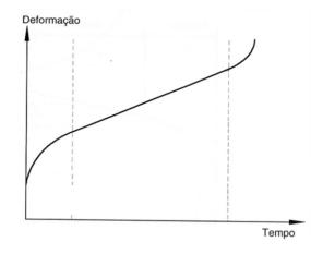
O gráfico apresentado refere-se a um ensaio de fluência, uma deformação permanente e dependente do tempo quando os materiais são submetidos a uma tensão constante.
